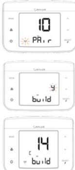
régulateur affichera le numéro du canal radio utilisé et accèdera au mode de configuration des paramètres « Parameter Setup » du dispositif. Après la configuration, placez le régulateur en mode « Identify » et mettez sous tension le régulateur sans fil pour ventilo-convecteur qui effectuera automatiquement le lien entre les deux dispositifs.
