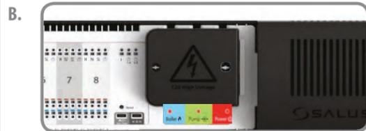
Retirer le couvercle de haute tension en desserrant les vis de fixation.
