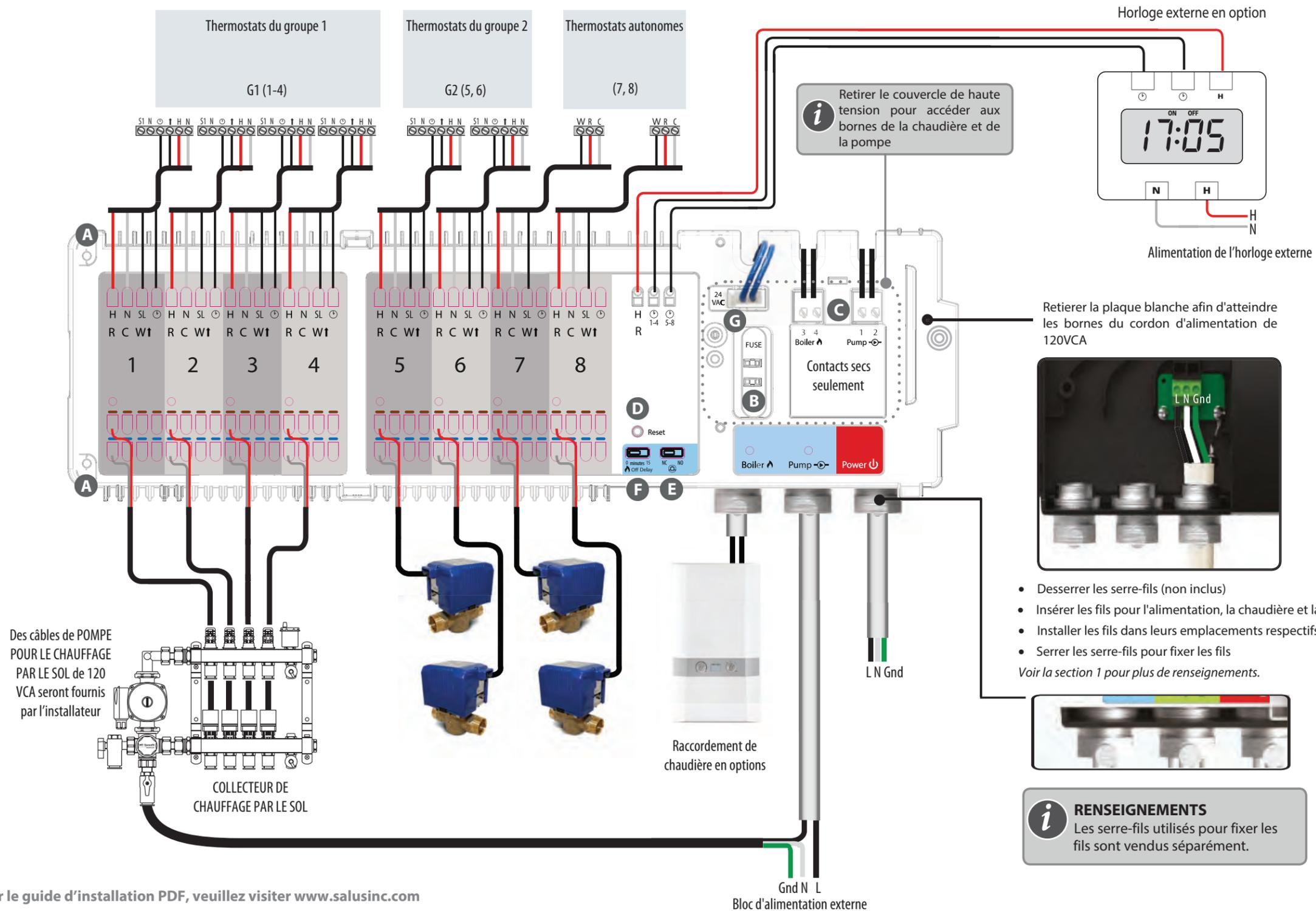
Des câbles de POMPE POUR LE CHAUFFAGE PAR LE SOL de 120 VCA seront fournis par l'installateur
