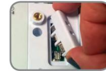
8 Remettre le couvercle de haute tension et le sécuriser à l'aide de deux vis.
