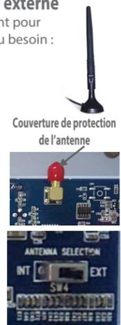
L'antenne externe permettra la connexion sans fil de l'appareil.
