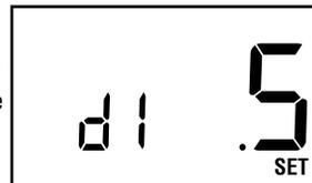
1. En el modo de funcionamiento normal, presione y mantenga presionado el botón **RETURN** (retornar) durante 4 segundos. La pantalla LCD mostrará "d1 x", donde "x" es igual a la configuración del diferencial en °F / °C. Esta es la configuración actual del diferencial de temperatura.
