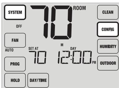
1. Appuyez et maintenez enfoncé les TouchPads « **SYSTEM** » et « **CONFIG** » (Configuration) pendant 3 secondes.
